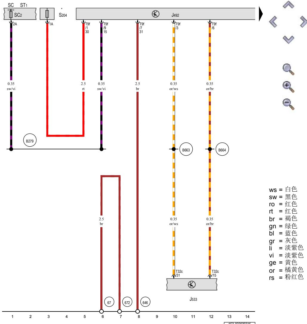
全轮驱动控制单元, 数据总线诊断接口, 保险丝 1 (30)
